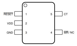
Figure 4-1. Pin Diagram
