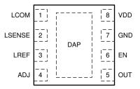
Figure 4-1. Pin Diagram
