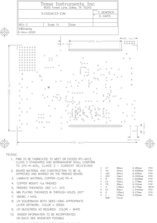
11. MINIMUM COPPER CONDUCTOR WIDTH IS: 8 MILS MINIMUM CONDUCTOR SPACING IS: 6 MILS
