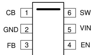
**Figure 4-1. Pin Diagram**
