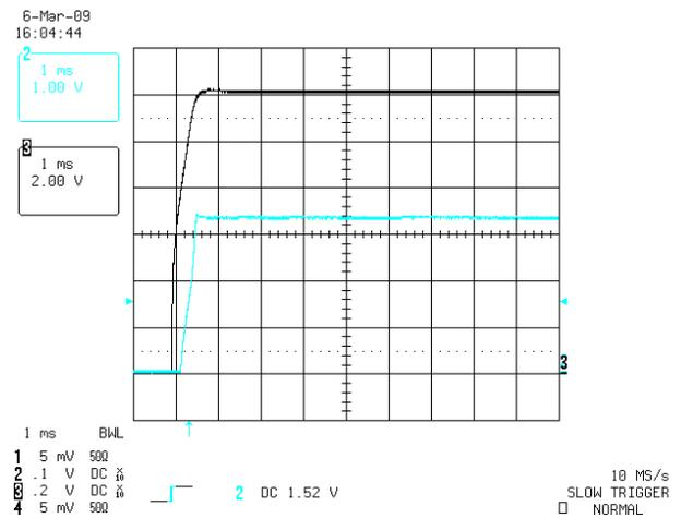
Figure 5. Startup  $V_{IN} = 12\text{ V}$ , No Load
