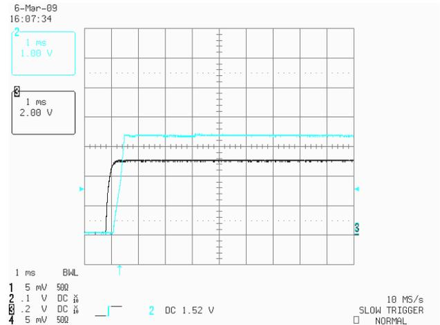
Figure 3. Startup  $V_{IN} = 5\text{ V}$ , No Load
