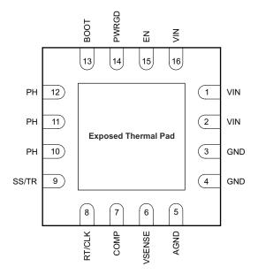
Figure 4-1. Pin Diagram
