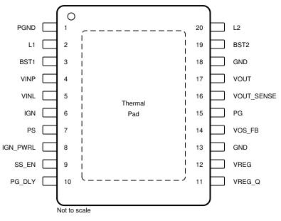
Figure 4-1. Pin Diagram
