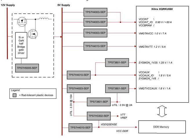
Figure 4-2. Rad-Tolerant Power for XQRKU060
