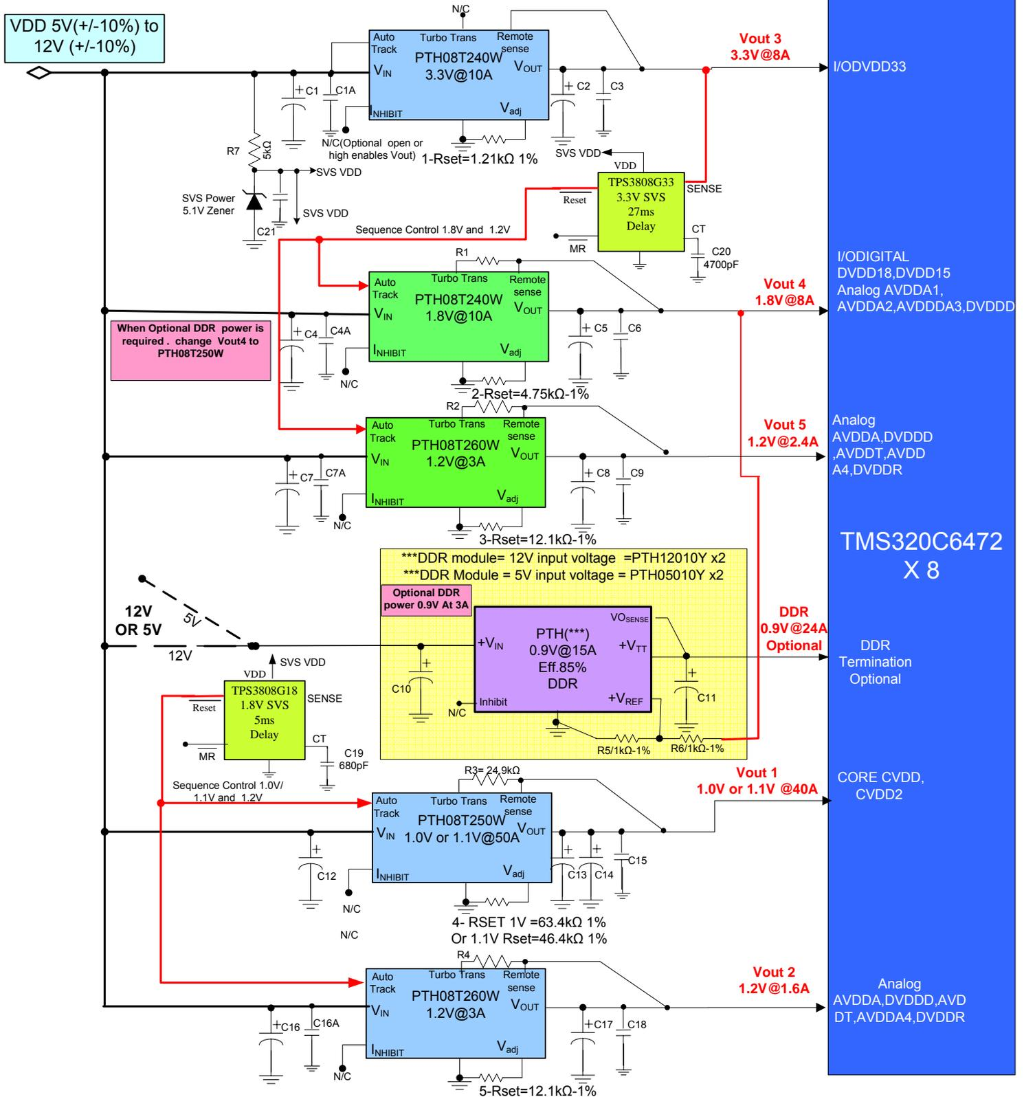
Sequence of Power : 1<sup>st</sup> Vout 3(3.3V) then 2<sup>nd</sup> Vout4 (1.8V),Vout 5 (1.2V) ,then 3<sup>rd</sup> Vout 1(1.0/1.1V) , Vout 2( 1.2V)
