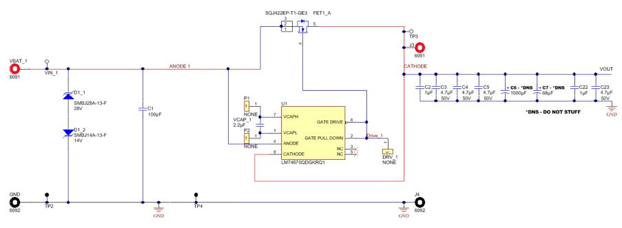
Figure 9. LM74670-Q1-SQEVM Schematic
