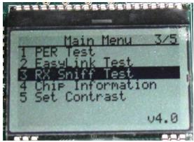
Figure 26 RX Sniff Test Menu
