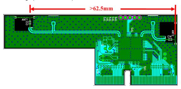
Figure 24. MIMO Antenna Spacing
