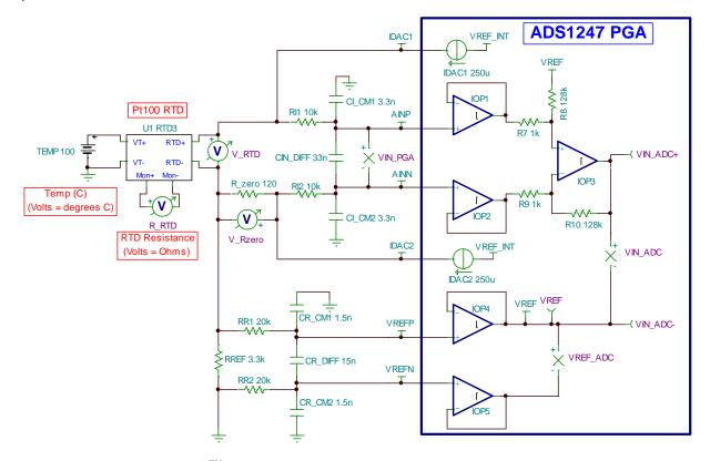
Figure 11. TINA-TI<sup>™</sup> Simulation Circuit for the RTD and ADS1247 Inputs
