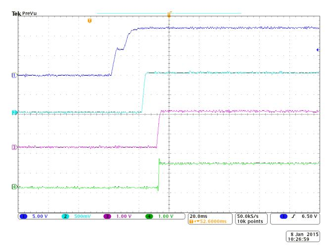
Ch.1: VIN Ch.2: VCCINT Ch.3: VCCAUX Ch.4: VCCO 1.2V
