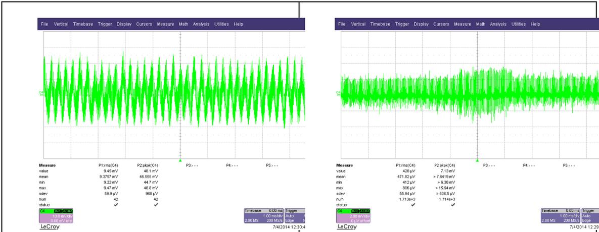
3.3V 264V 600mA Load Ripple and Noise
