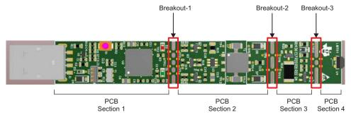
Figure 30. TIDA-00752 TI Design Subsystem Hardware
