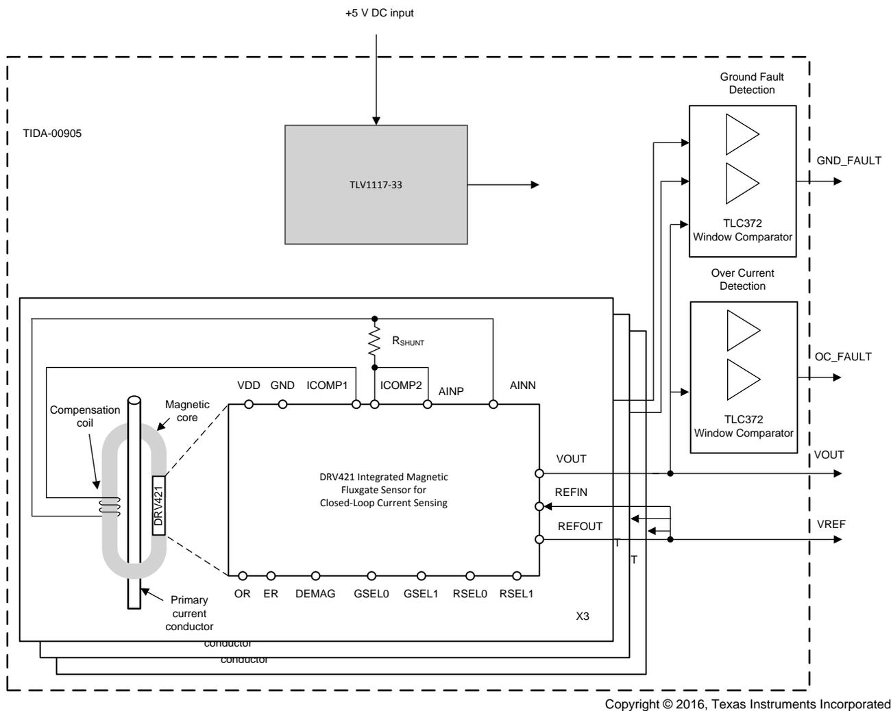
**Figure 2. TIDA-00905 Block Diagram**
