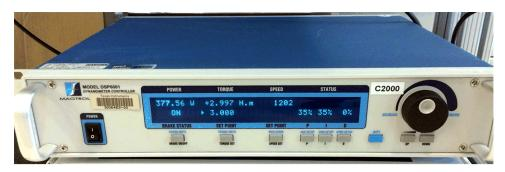
Figure 19. Dynamometer Controller
