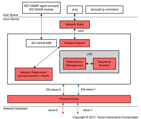
Figure 10. Linux<sup>®</sup> HSR Architecture
