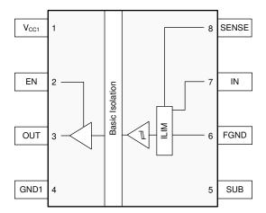
Figure 2-6. ISO1211 Pin Diagram
