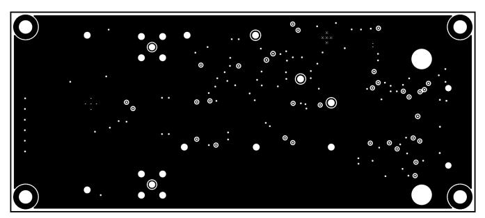
Figure 14. REF6025EVM PCB Layer 2: GND Plane
