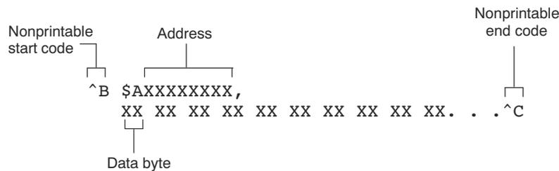
**Figure 12-6. ASCII-Hex Object Format**
