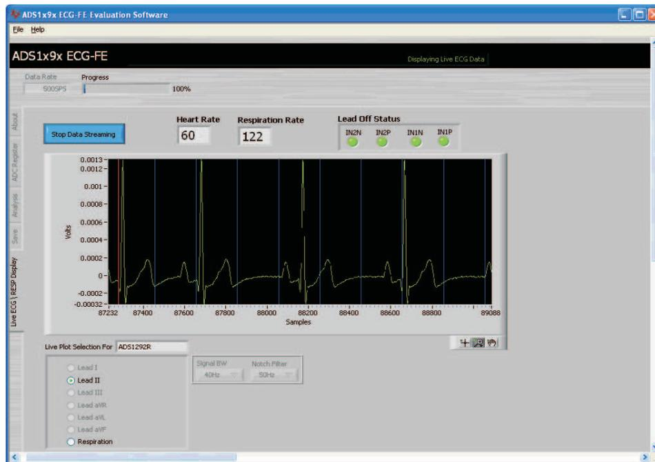
Figure 31. PC Application Live ECG for ADS1292R
