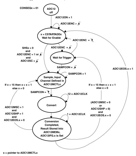
Figure 1-8. Sequence-of-Channels Mode
