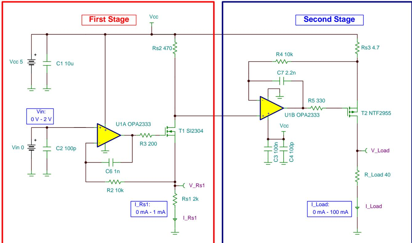
Figure 3. TINA-TI™ - Schematic
