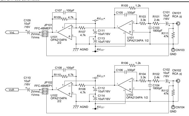
Figure 2-4. DEM-DAI1808 Analog Section
