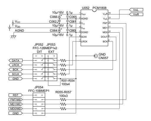
Figure 2-3. DEM-DAI1808 ADC Section
