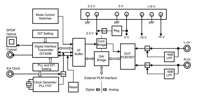
Figure 1-1. DEM-DAI1808 Block Diagram
