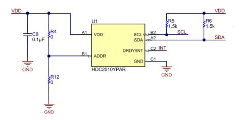
Figure 2. HDC2010EVM : Sensor Module
