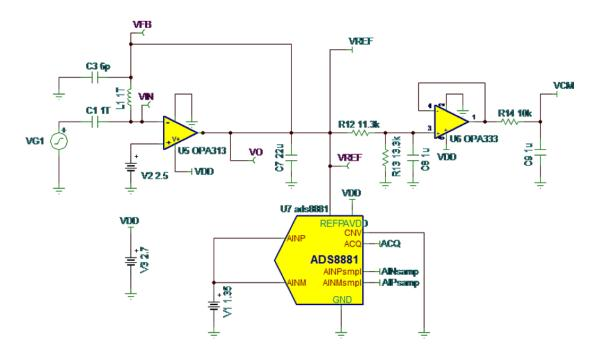
Figure 31. TINA-TI Simulation Schematic
