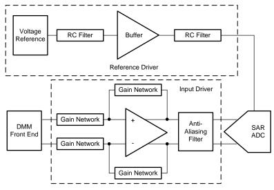
Figure 25. SAR ADC Subsystem Block Diagram
