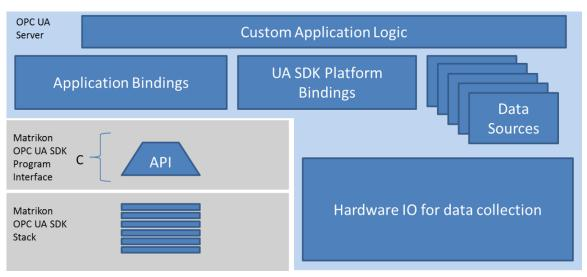
Figure 3. Matrikon OPC UA SDK Server Components
