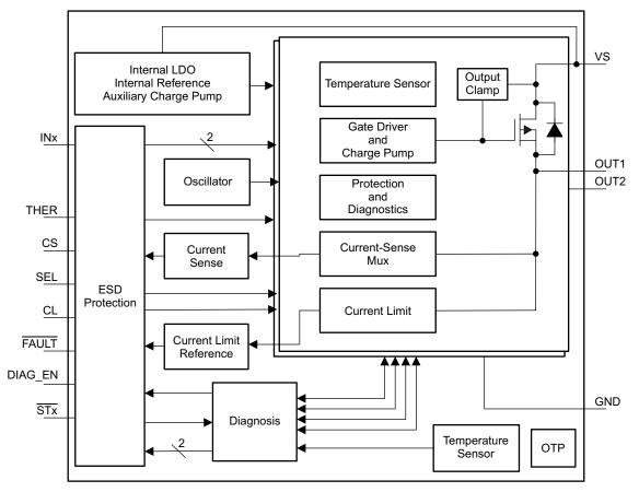
Figure 3. TPS2H000-Q1 Block Diagram
