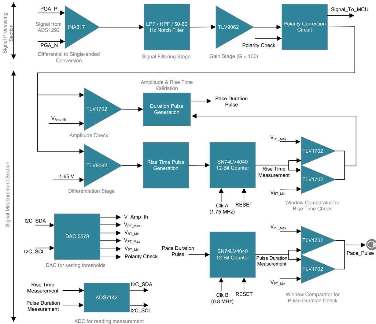
**Figure 4. TIDA-010005 System-Level Block Diagram**
