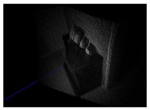
(d) Point Cloud From Gaussian-Filtered Depth Map
