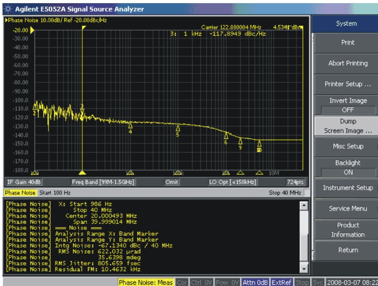
Figure 14. CDCE62005 122.88-MHz HS-LVPECL Output Phase Noise
