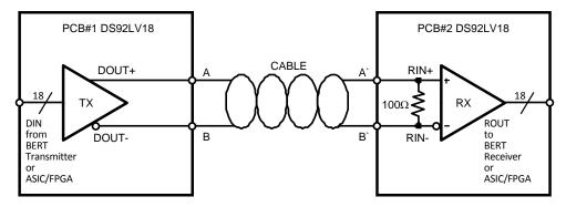
Figure 10. DS92LV18 SerDes BER Test Setup
