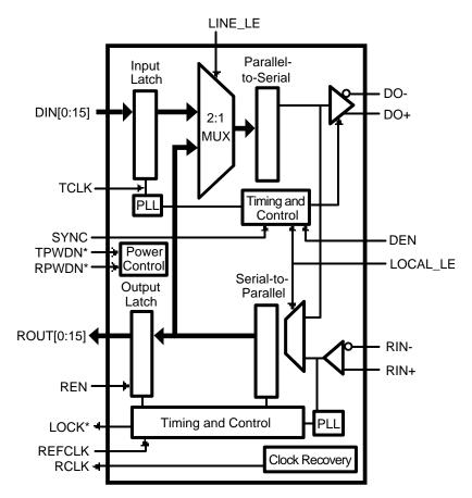
Figure 3. DS92LV16 Block Diagram
