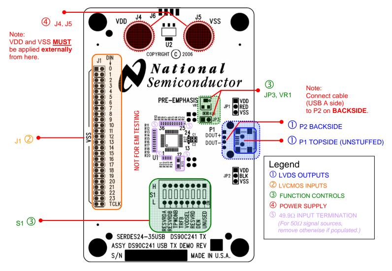
Figure 2. DS90C241 Tx Evaluation Board
