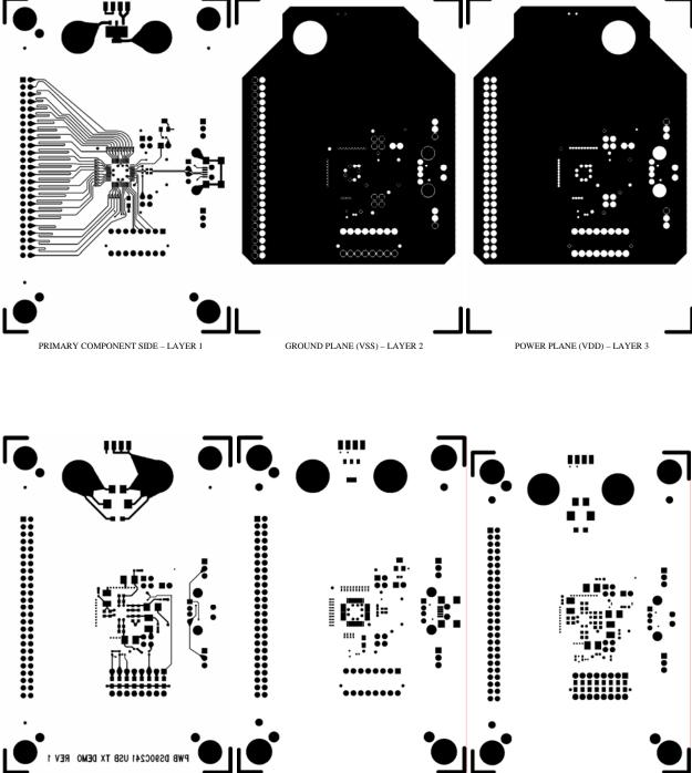
SECONDARY COMP SIDE - LAYER 4 PRIMARY COMP SIDE - SOLDER MASK (LAYER 1) SECONDARY COMP SIDE - SOLDER MASK (LAYER 4)
