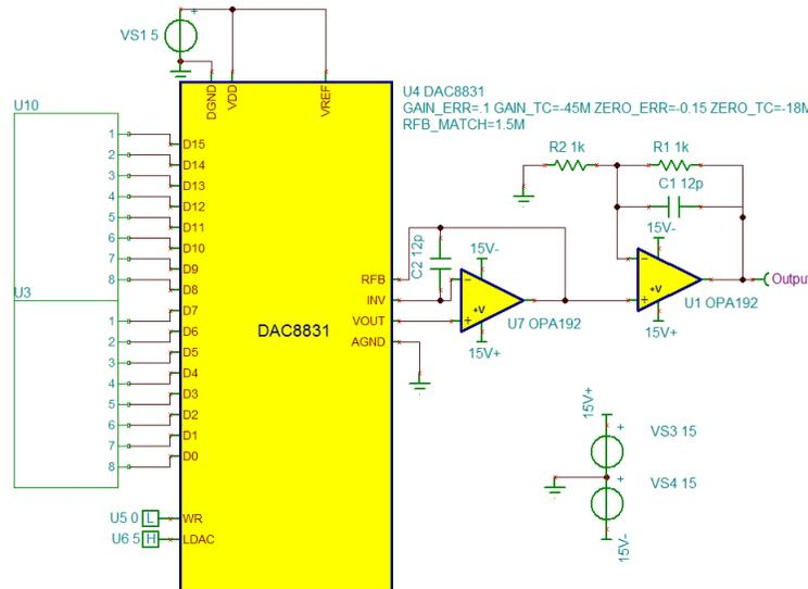
**Figure 7. TINA-TI™ Simulation Schematic**
