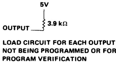
**FIGURE 1 – LOAD CIRCUIT**
