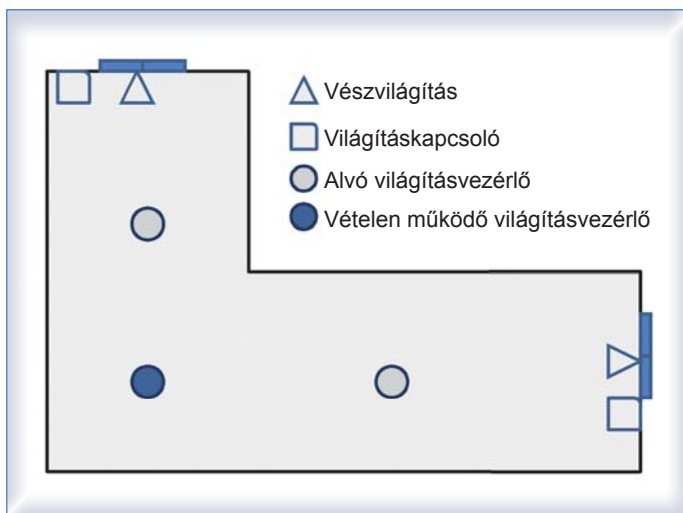
4. ábra Kis terem világításvezérlő hálózata
