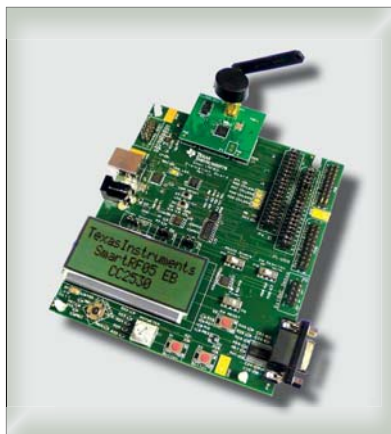
2. ábra A koordinátor és a router megvalósítására alkalmas Texas Instruments-fejlesztőhardver
