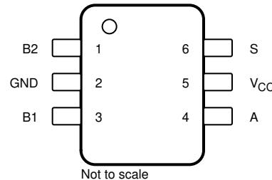
図 5-2. DCK Package, 6-Pin SC70 (Top View)
