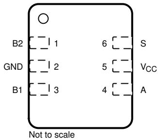
図 5-5. DSF Package, 6-Pin SON (Top View)
