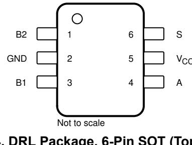
図 5-4. DRL Package, 6-Pin SOT (Top View)
