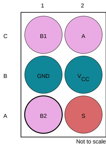
图 5-7. YZP Package, 6-Pin DSBGA (Bottom View)
