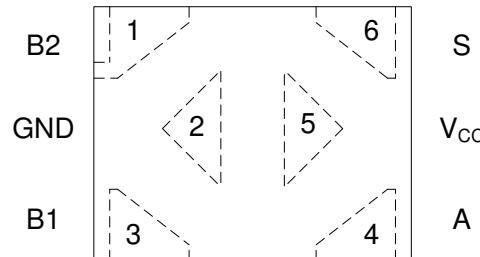
図 5-6. DTB Package, 6-Pin X2SON (Top View)
