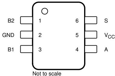
図 5-1. DBV Package, 6-Pin SOT-23 (Top View)
