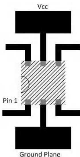
图 11-1. Recommended Layout Example
