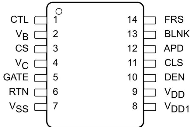
图 6-1. PW Package 14-Pin TSSOP Top View
