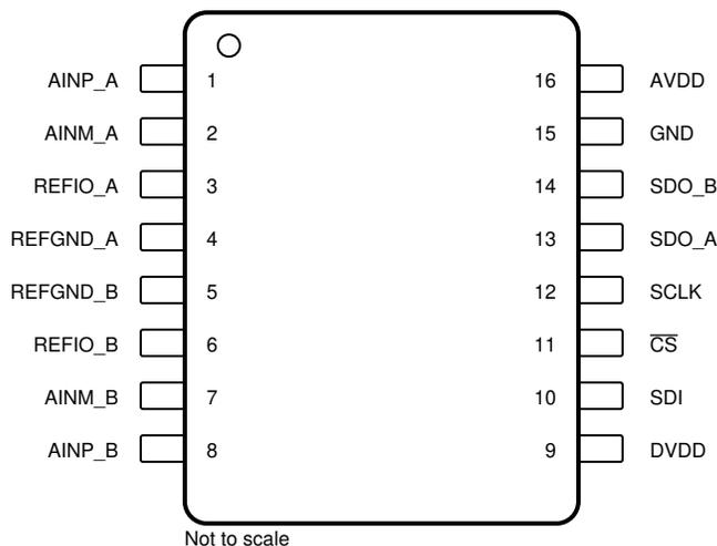
**Figure 4-1. Pin Diagram**
