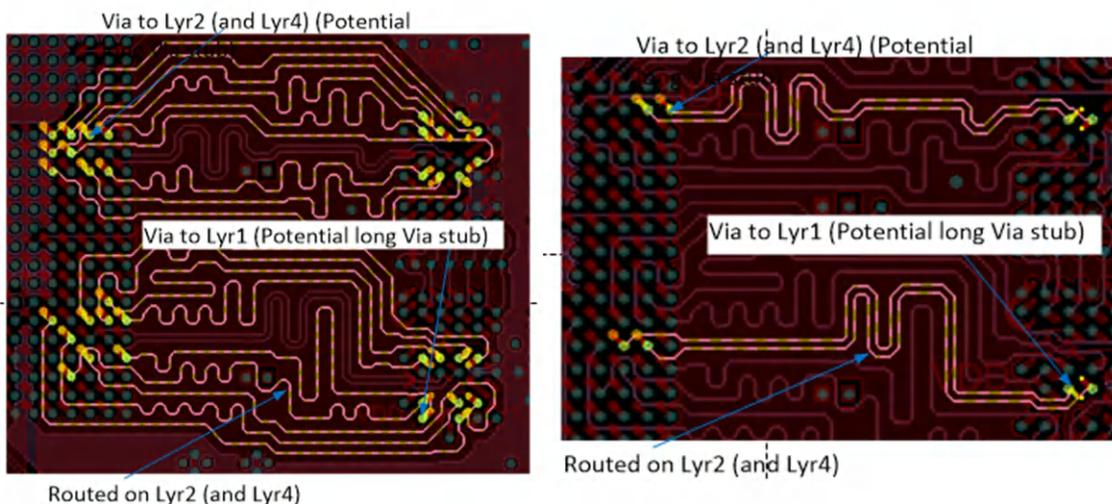
**Figure 3-9. Example LPDDR4 Data Byte(s) and DQS(s) Routing**
