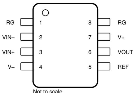
**Figure 4-1. Pin Diagram**
