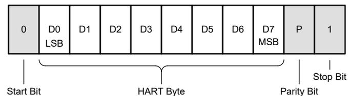
**Figure 1-9. The HART Protocol Byte**
