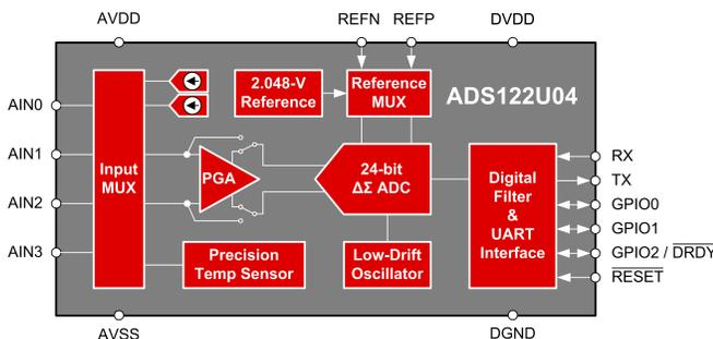
Figure 2. ADS122U04 Block Diagram
