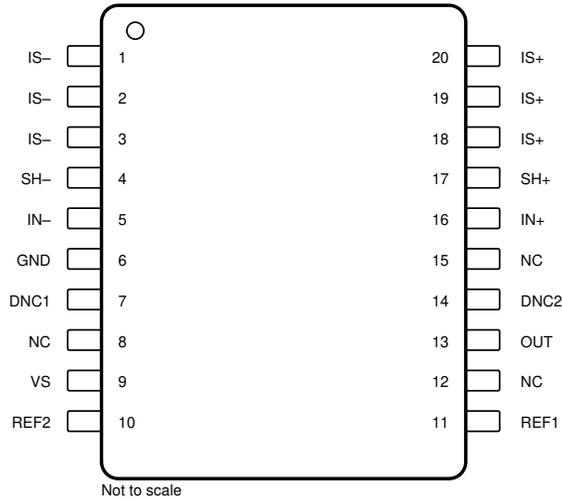
图 5-1. PW Package 20-Pin TSSOP Top View
