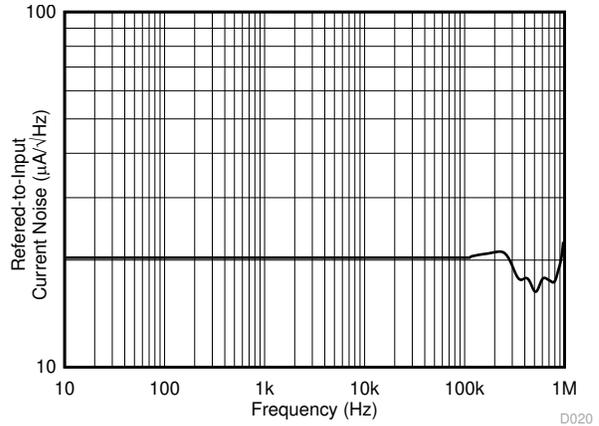
**图 6-20. INA253A1-Q1 Input-Referred Voltage Noise vs Frequency**
