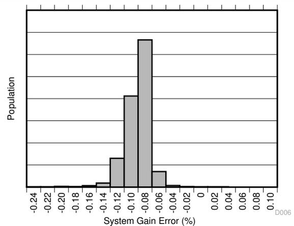
图 6-6. Gain Error Production Distribution (INA253A1-Q1)
