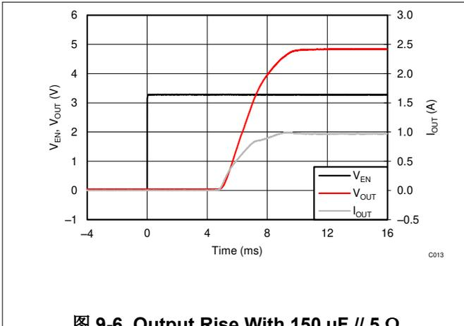
图 9-6. Output Rise With 150  $\mu$ F // 5  $\Omega$
