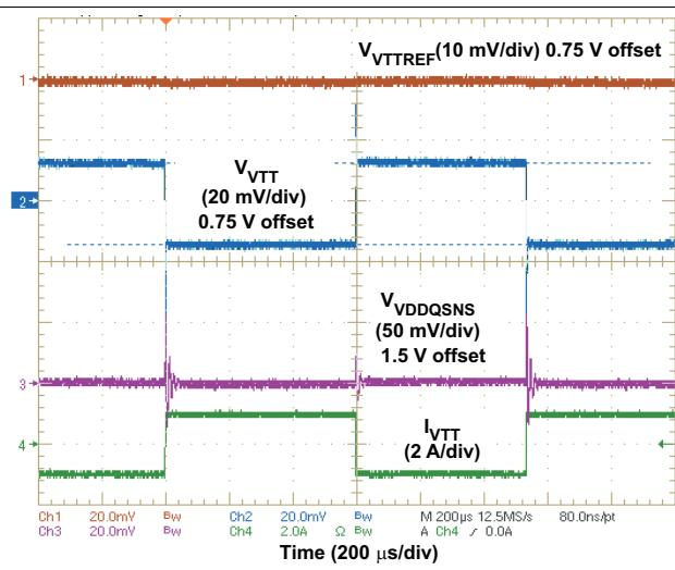
图 14. VTT Load Transient Response (0.75 V)
