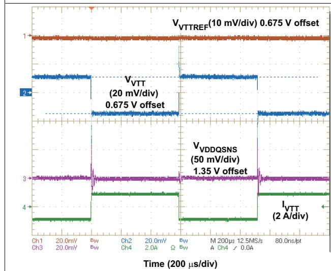
图 15. VTT Load Transient Response (0.675 V)
