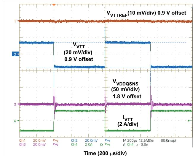
图 13. VTT Load Transient Response (0.9 V)
