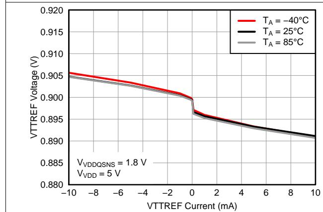
图 5. VTTREF Load Regulation (0.9 V)
