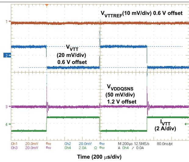
图 16. VTT Load Transient Response (0.6 V)
