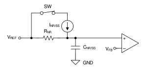
图 41. Simplified Soft-Start Circuit
