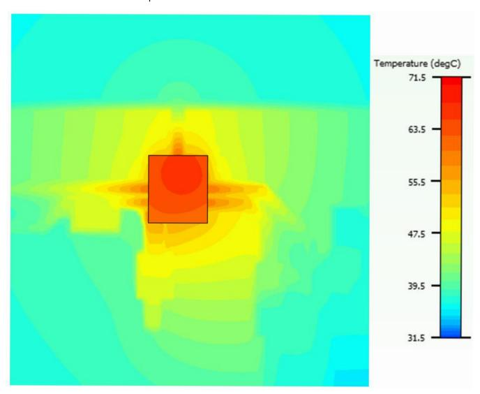
图 53. PCB Thermal Gradient
