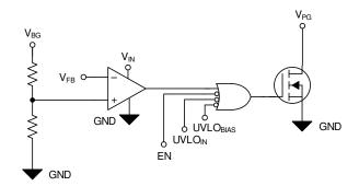
图 43. Simplified PG Circuit
