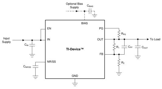
图 44. Typical Circuit
